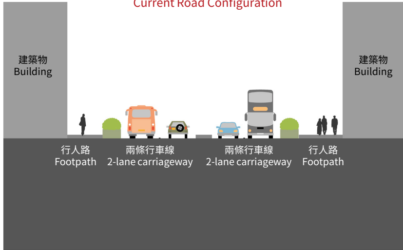
現時路面情況 Current Road Configuration
